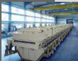
Линии травления выполнены из полипропилена
