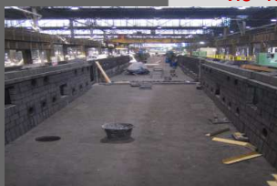
Линии травления выполнены из полипропилена
