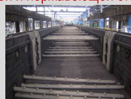
Линии травления выполнены из полипропилена
