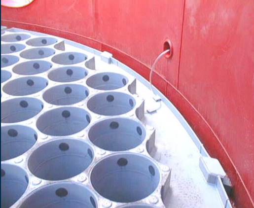
Система внутреннего заземления с встроенными графитовыми дисками
